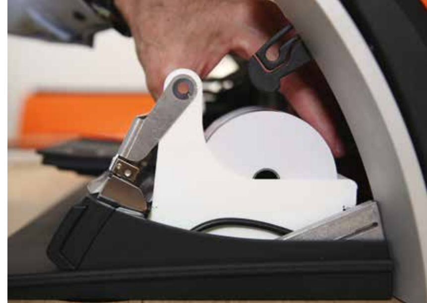
Achsenlose Bonrollen und easy-paper-load für blitzschnellen Rollenwechsel
